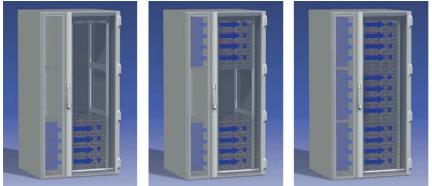
Abb. 10: Liquid Cooling Package bestückt mit einem, zwei oder drei Modulen
